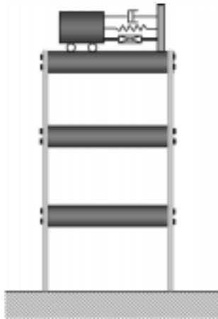
그림 3 AMD가 설치된 3층 전단건물
